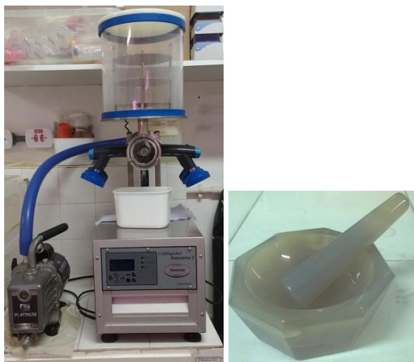
Liofilizador utilizado para a desidratação à vácuo do testemunho GL-1109 (à esquerda); Grau de ágata utilizado para macerar as amostras subamostrada e liofilizadas (à direita), Laboratório de Geoquímica Orgânica (Lab-404/GEOQ-UFF).
